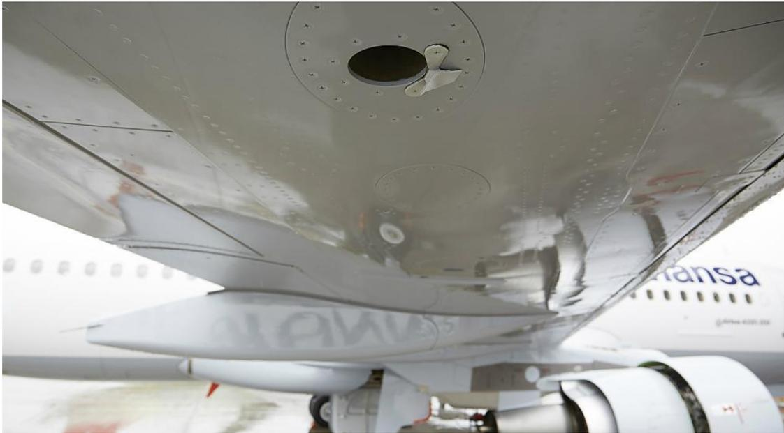
**Abbildung 47: Ein Wirbelgenerator an der Tankdruckausgleichsöffnung montiert ©UNH<sup>163</sup>**
